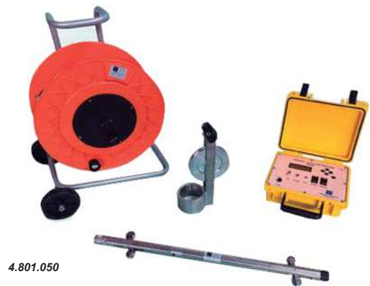
4.688.210 - Dilatômetro de Marchetti DMT - Conjunto Padrão
