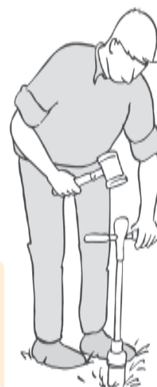
O suporte com o anel amostrador é então introduzido no solo por percussão com o martelo anti-repique.
